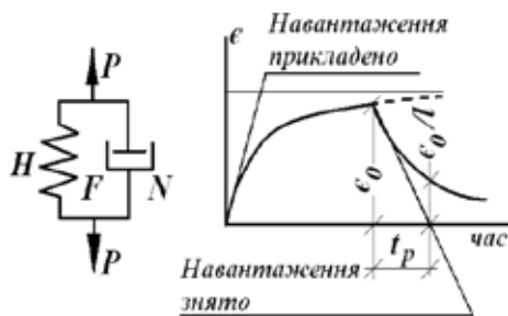
Рис. 6. Модель-імітатор в'язко-пружного тіла (реологічне тіло Фойгта)
